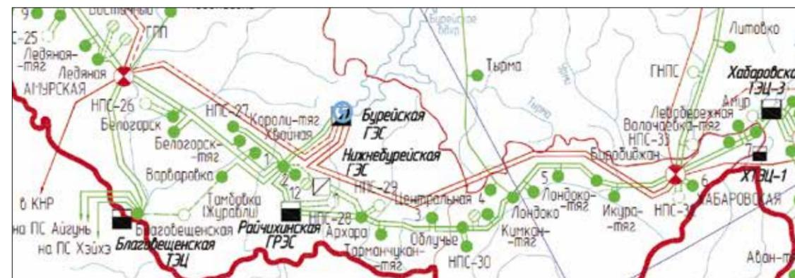
Рисунок 3.79. Схема выдачи мощности Бурейской ГЭС.
