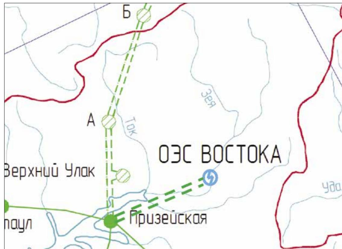
Рисунок 3.51. Схема выдачи мощности Локшанской ГЭС.
