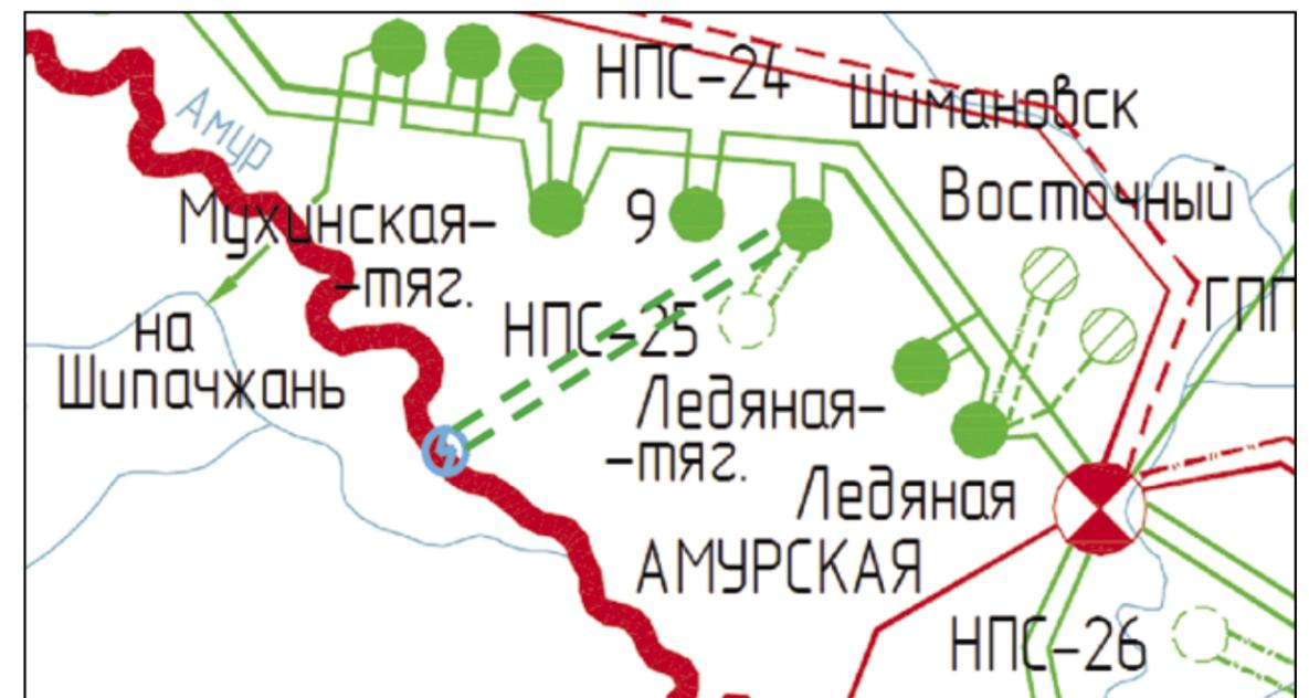
Рисунок 3.1. Схема выдачи мощности Нововоскресеновской ГЭС.
