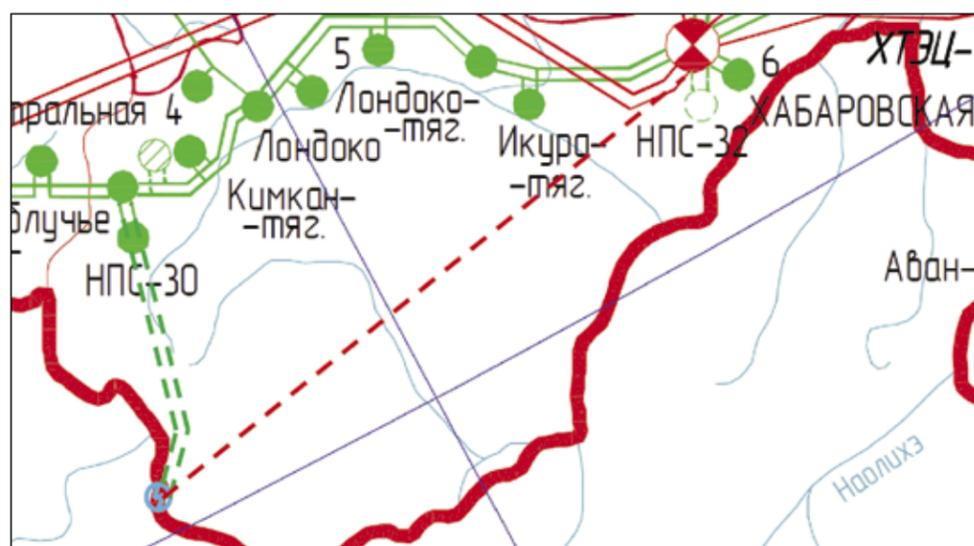
Рисунок 3.10. Схема выдачи мощности Хинганской ГЭС.
