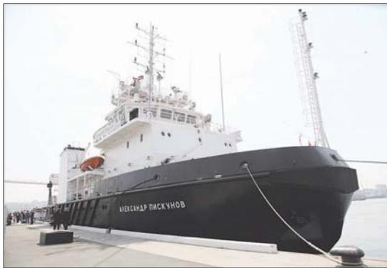
Морской буксир имеет неограниченный район эксплуатации, в том числе арктические моря. Дальность плавания при скорости 12 узлов составляет 4 тысячи миль. Предназначен он для выполнения буксировочных работ, тушения пожаров на авиарейсовых кораблях и береговых сооружений, выполнения водолазных работ на глубинах до 20 метров.
