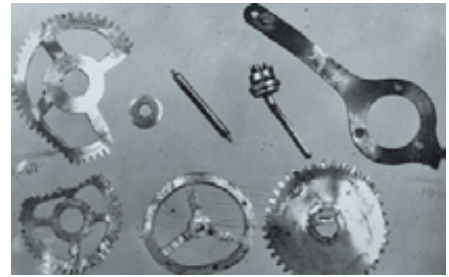
НАЧИНКА БОМБЫ ВОЛЫНСКОГО (СЛЕВА) И ДЕТАЛИ ЧАСОВОГО МЕХАНИЗМА ВЗРЫВНОГО УСТРОЙСТВА
