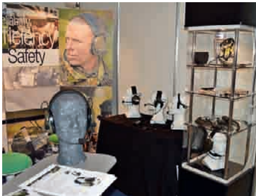
ТАКТИЧЕСКИЕ НАУШНИКИ С ГАРНИТУРОЙ, ОСЛАБЛЯЮЩИЕ ВОЗДЕЙСТВИЕ СИЛЬНОГО ШУМА И УСИЛИВАЮЩИЕ СЛАБЫЕ ЗВУКИ, ПОЗВОЛЯЮТ ВЕСТИ ДВУСТОРОННИЕ ПЕРЕГОВОРЫ
