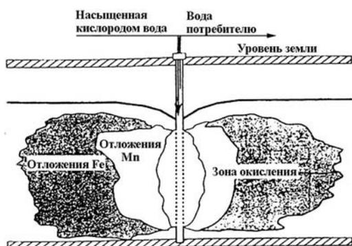
Рис. 1. Формирование биогеохимического реактора по подготовке питьевых подземных вод в водоносном горизонте у эксплуатационной скважины
