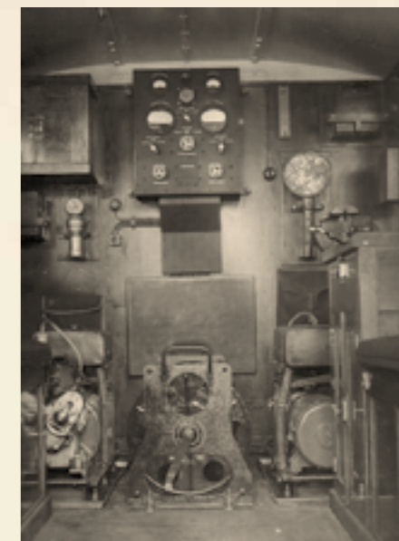
АРМЕЙСКИЙ ПРИЕМО-СЛЕЖЕЧНЫЙ УЗЕЛ АСУ И ЕГО «НАЧИНКА» (СПРАВА) ДЛЯ ПЕРЕХВАТА РАДИОТЕЛЕФОННОЙ И РАДИОПЕЛЕНГАТОРНОЙ РАБОТЫ
