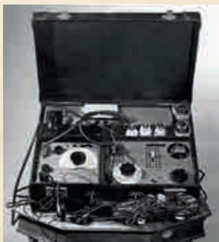
ПОРТАТИВНАЯ КОРОТКОВОЛНОВАЯ ПРИЕМО-ПЕРЕДАЮЩАЯ РАДИОСТАНЦИЯ, СМОНТИРОВАННАЯ В ЧЕМОДАНЕ. ТАКИМИ РАДИОСТАНЦИЯМИ ПОЛЬЗОВАЛИСЬ АГЕНТЫ ГЕРМАНСКОЙ ВОЕННОЙ РАЗВЕДКИ
