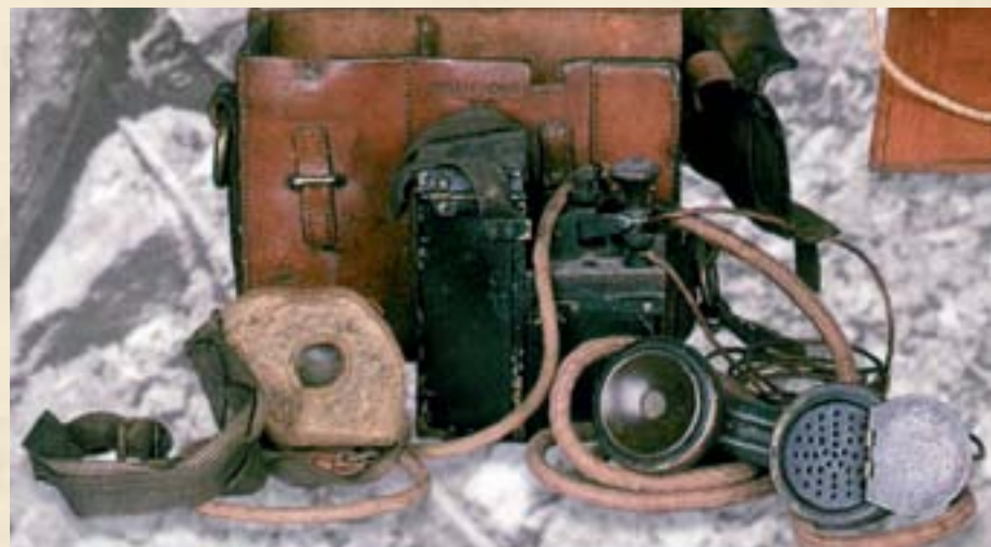
ПЕРЕНОСНОЙ ПОЛЕВОЙ ТЕЛЕФОН ПОМИМО ПЕРЕГОВОРНОЙ ТРУБКИ ИМЕЛ КЛЮЧ ДЛЯ ПЕРЕХОДА НА МОРЗЯНКУ
